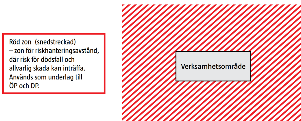
Figur 2-2. Illustration som visar schabloniserade riskhanteringsavstånd som angetts som "större än", vilket illustreras med en snedstreckad röd zon från fastighetsgräns. Det gäller för explosiva varor, giftiga gaser, giftiga ämnen och frätande ämnen. I dessa fall bör risken för dödsfall och skada beaktas till angivet riskhanteringsavstånd. För dessa planeringsfall är det särskilt relevant att ta fram ett verksamhetsanpassat riskhanteringsavstånd [3].
