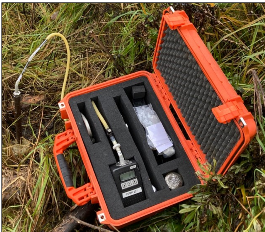
Figur 14. Provtagningsuppställning i provpunkt 23AF04P där porgasspjut, slangkoppling, kolrör A, kolrör B, silikonslang och lågflödespump kan ses.
