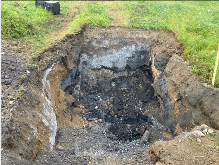
Figur 10. Provpunkt 23AF19 med blandat fyllningsmaterial innehållande olika avfallsfraktioner.
