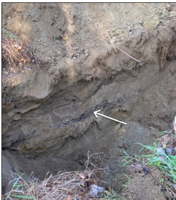
Figur 13. Provpunkt 23AF09, fyllnadsmaterial av sand överlagrar naturlig sand. De olika sandlagren åtskiljs av ett tunt mullskikt som bedömdes vara den ursprungliga markytan (pilen i fotot pekar på mullskiktet).
