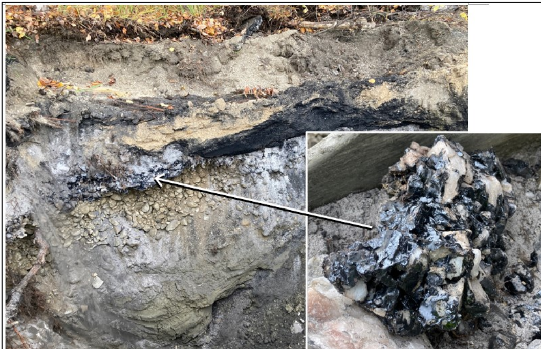
Figur 11. Provpunkt 23AF07 med blandade skikt av olika avfallsfraktioner i den översta metern, bland annat tjärindränkt kvarts i bilden till höger (pilen i fotot pekar på skikt med tjärindränkt kvarts).
